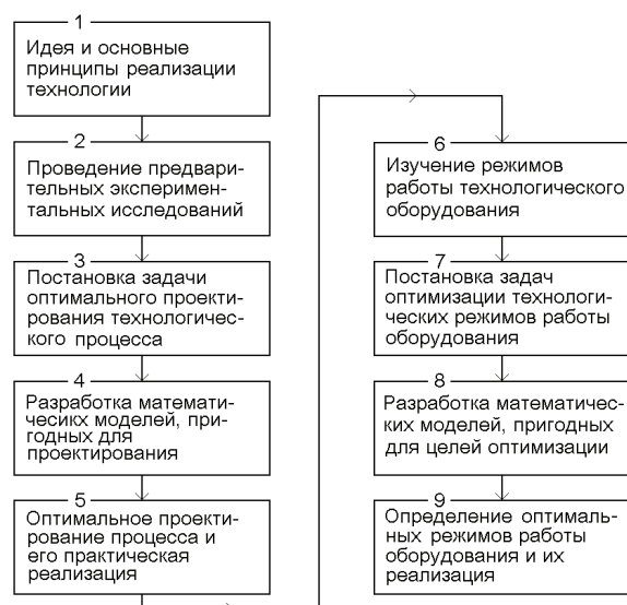
Рис. 3.3. Основные этапы оптимального проектирования и оптимизации биотехнологического процесса при использовании математического моделирования
